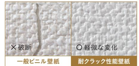
一般ビニル壁紙が破断するとき、
