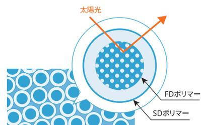
芯部に酸化チタンを多く含むポリエステル素材 (FDポリマー) を採用。繊維の外側を従来のポリエステル素材 (SDポリマー) で包み込む二重構造によって、薄手の生地でも遮熱効果を実現することに成功しました。
