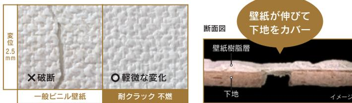
引張試験速度：3mm/min
